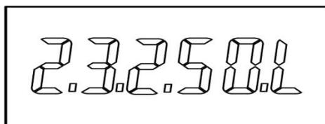
“2.3.2.50.L”表示：当测头数据超过最小值(起点)0.05mm 时开始计时自动判断输出，如果 0.3 秒内数据变化不超过 0.01mm，则输出公差结果，反之，不输出；但如果超过 50 秒后强行输出公差结果；
